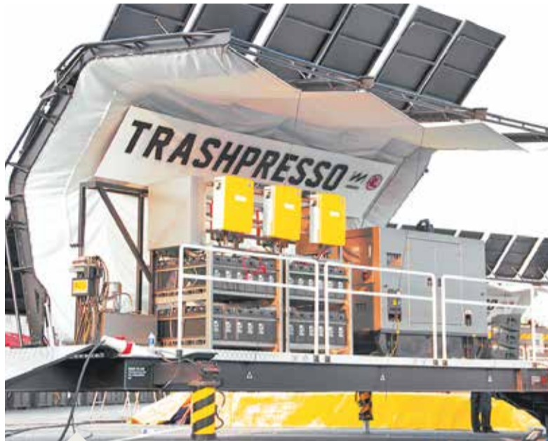
Мобильный мини-завод Trashpresso перерабатывает мусор в материал для архитектурной плитки
